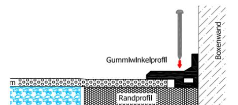
Profil d'assemblage en caoutchouc pour raccorder la surface plane.
